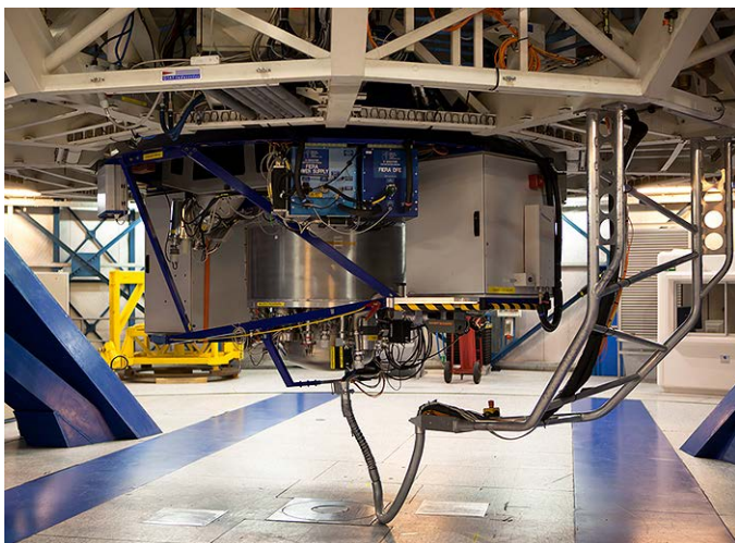
Fig. 1. El espectrógrafo X-shooter del VLT. Tiene un rango muy ancho: desde 300 hasta 2.500 nm, es decir desde el ultravioleta hasta el infrarrojo cercano. Es muy adecuado para observar multitud de fenómenos, especialmente los de muy alta energía.
